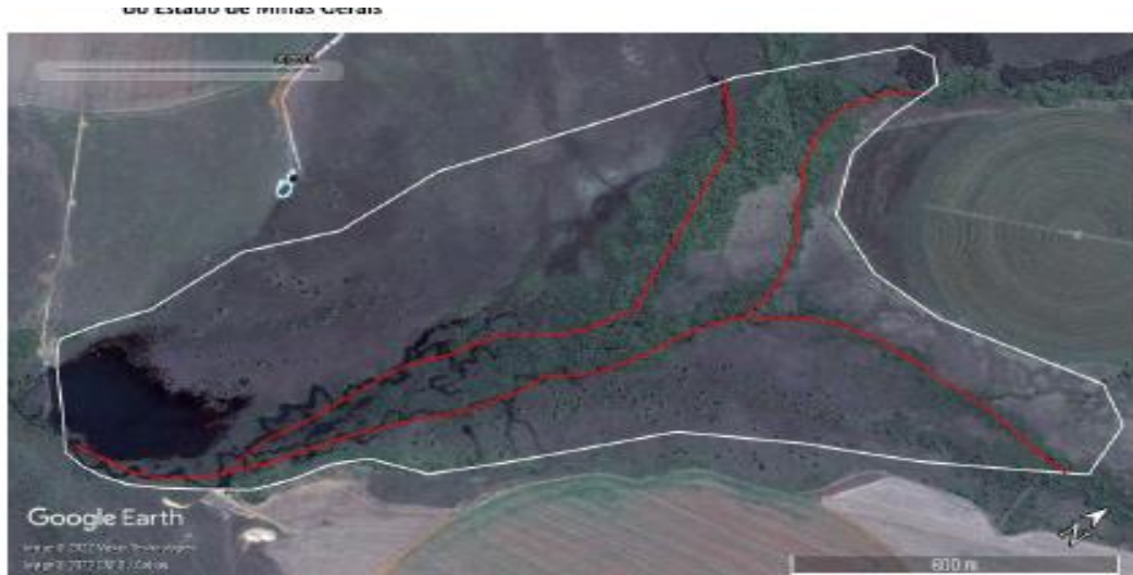
Figura 2 - Imagem de satélite anterior à ampliação, com a indicação aproximada da área inundada (em branco) e dos canais de drenagem (em vermelho). Nota-se que próximo aos canais há uma vegetação arbórea mais densa (típica das áreas de fundo das veredas) e mais afastado dos canais há uma vegetação campestre com indivíduos isolados de buritis (típica das áreas do meio e das bordas das veredas).
