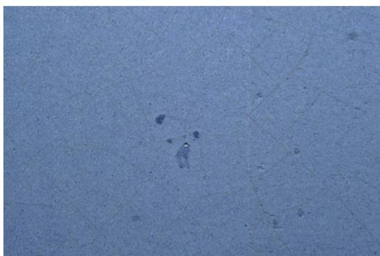
**Figura 11:** Detalhe dos esmaltes com manchas.
