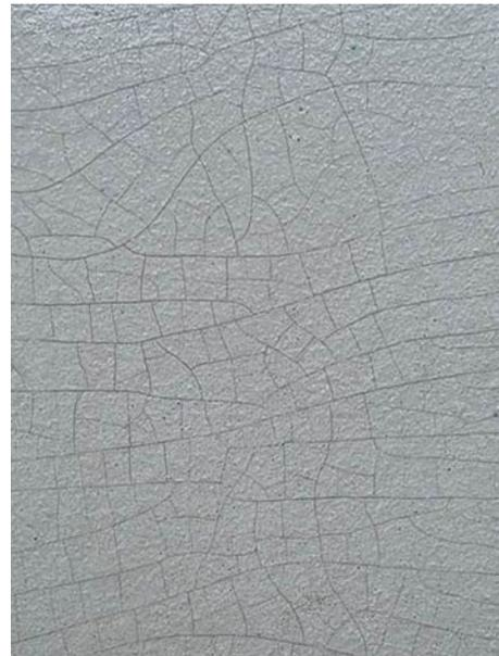
**Figura 8:** Detalhe do esmalte com craquelê - lajota C55.
