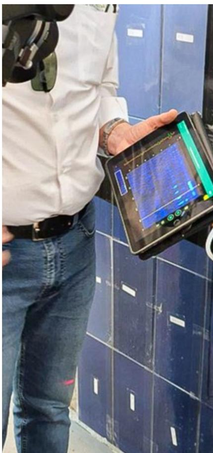
Figura 23: Análises por GPR diretamente sobre o painel.
