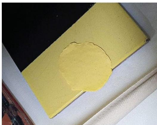
**Figura 62:** Testes das massas a base de pó de quartzo e Paraloid B44® pigmentadas.
