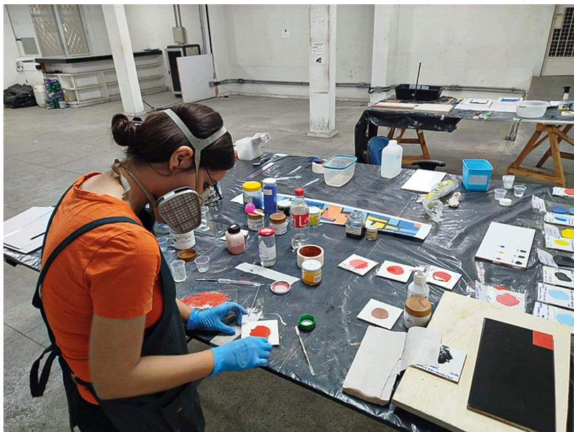
O nivelamento das lajotas foi realizado com o uso de uma massa à base de pó de quartzo (malha 500) aglutinada em Paraloid B44® a 30% em p-Xileno e pigmentada com pigmentos em pó de alta qualidade. Essa massa apresentou um aspecto de vidro muito próximo das placas originais o que facilitou muito a fase final de reintegração e apresentação estética (Figuras 63 a 75) .
